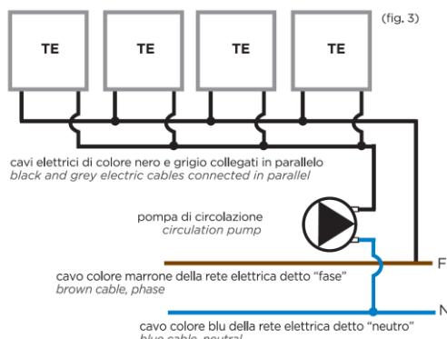
Collegamento teste termoelettriche con contatto di fine corsa e pompa di circolazione per impianto di riscaldamento.
