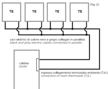
Collegamento teste termoelettriche con contatto di fine corsa e caldaia con "termostato ambiente".
